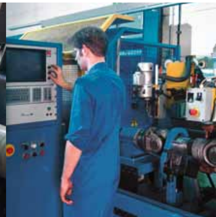
Modernste EDV-gestützte Wuchttechnik ist ein weiterer Garant für den einwandfreien Lauf der gefertigten Gelenkwellen.
