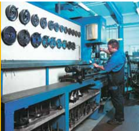
Auf eigens dafür ausgelegten Richtpressen werden alle Gelenkwellen vor dem Auswuchten vorgerichtet.
